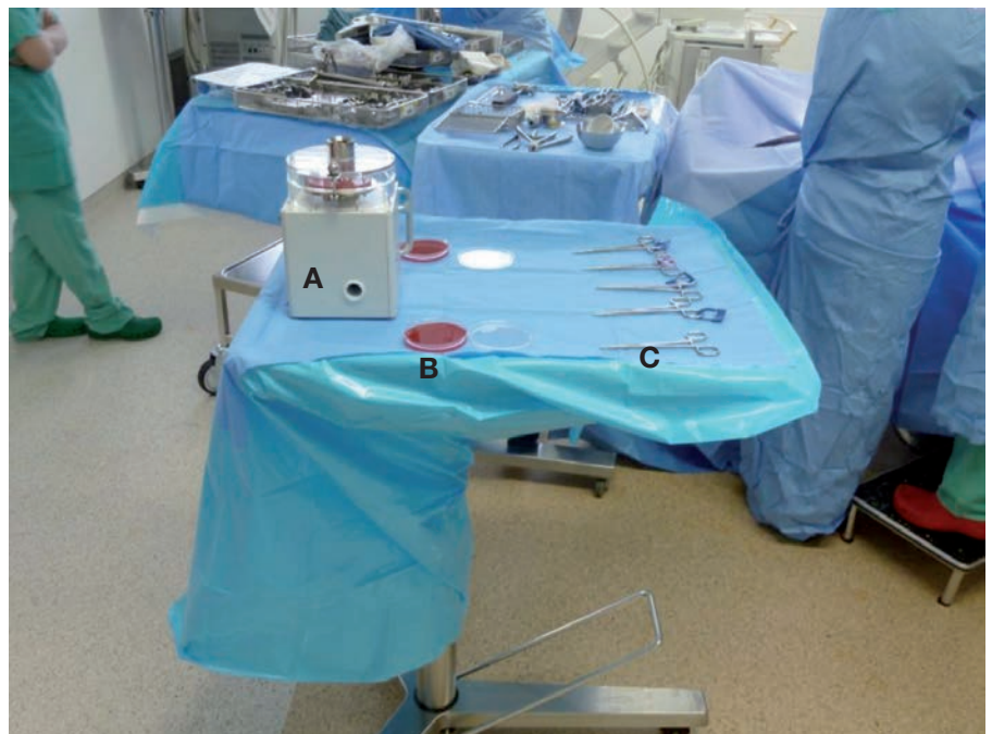
Abbildung 1: Probenstisch mit Probenanordnung. A) Luftkeimsammler, B) Sedimentationsplatten, C) Crile-Klemmen.
